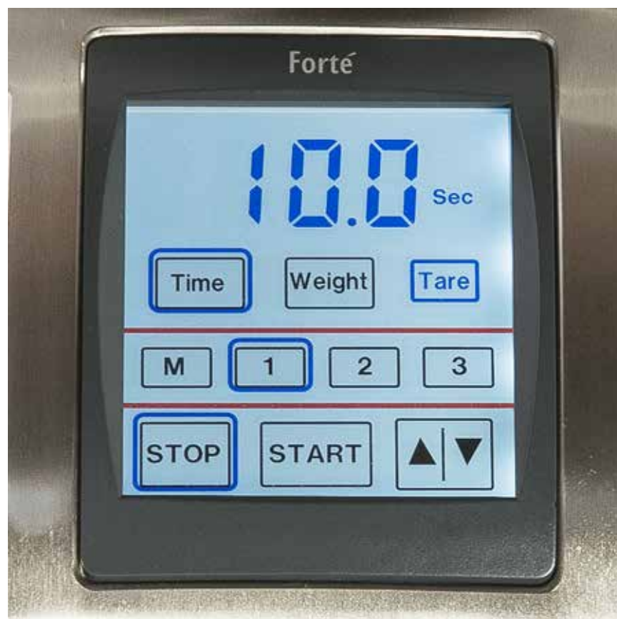
Tous les réglages de poids et de temps se font sur l'écran tactile.
