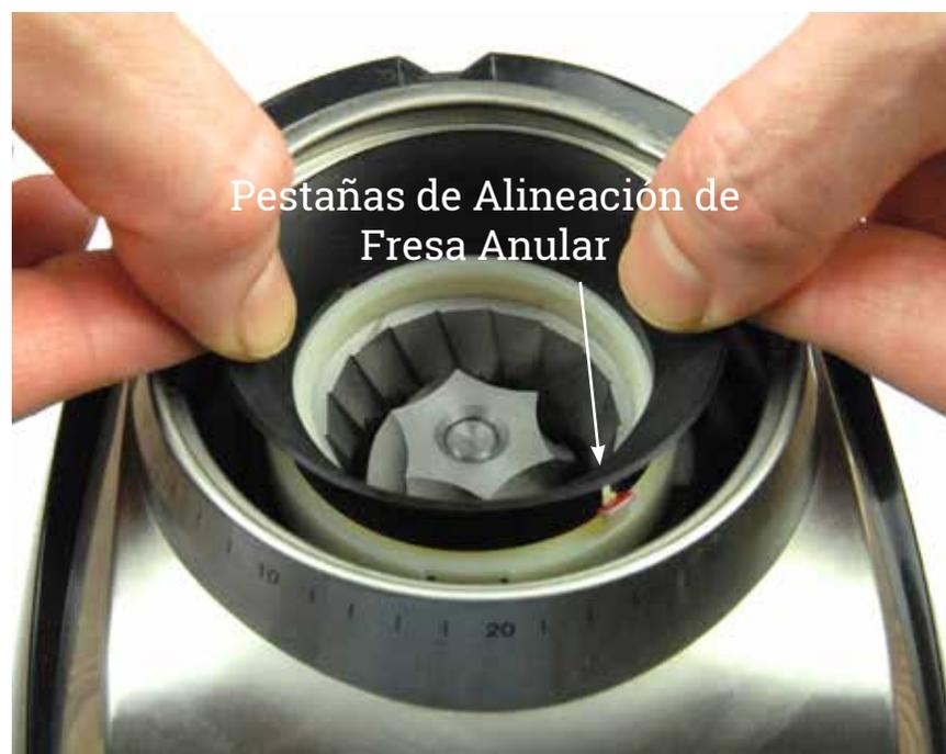
en la fresa, con la saliente rectangular en el anillo negro de ajuste. Menee y empuje hacia abajo firmemente la fresa anular para asegurarse que esté bien asentada. Después de reemplazar la fresa, también reemplace el sello de silicón alineando las dos ranuras en el sello de silicón con las pequeñas pestañas en la parte superior de la fresa anular y deslice el sello sobre la fresa anular.
